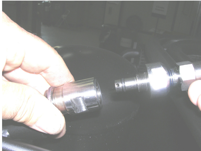
Ábra 6 – Biztonsági szelep mozgó részének leszerelése
